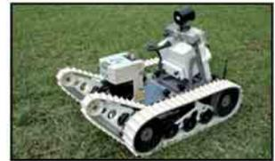
**PRM** est un robot intermédiaire (20 kg) conçu pour des missions d'inspection et de reconnaissance. Sa conception modulaire permet d'accueillir facilement tout type de charges utiles orientées métier (perception visuelle et sonore, surveillance, autoprotection, vision panoramique, assistance à la téléopération).
