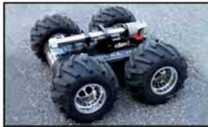
**COBRA** est un petit robot de 5 kg dédié aux missions d'inspection et d'intervention en intérieur ou en extérieur. Il dispose d'une gamme d'accessoires (disrupteur, capteurs, ...) permettant la détection et la neutralisation de colis piégés. Sa forte résistance aux chocs lui permet d'être projeté à plusieurs mètres.
