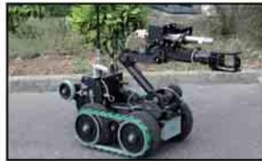
**CASTOR** est un robot téléopéré de 50 kg principalement dédié aux missions EOD/IEDD et contrôle NRBC. Sa robustesse et sa fiabilité en font un système sûr, opérationnel 24 heures sur 24 et capable d'être déployé rapidement sur zone.
