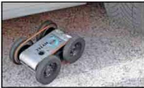
**INBOT** est un petit robot téléopéré de 2,1 kg projetable disposant d'un large champ de vision avec ses 3 caméras. INBOT est conçu pour des missions d'inspections en environnement confiné dans des contextes de guerre urbaine, contrôle sécuritaire, attaques anti-terroristes.
