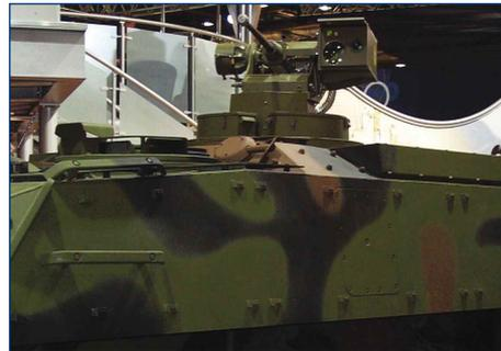
Stabilisé, le tourelleau SWARM est un système complet prêt à l'intégration. Il se compose de la tourelle équipée à monter
