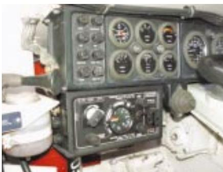
Cette modification a pour but de permettre de manière réversible d'adapter la pression des pneumatiques à la nature du terrain et, ainsi, d'augmenter très sensiblement la mobilité tactique du véhicule.
